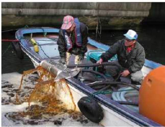
EM活性液は、ポンプを使って投入されます。 (道頓堀川にて)
